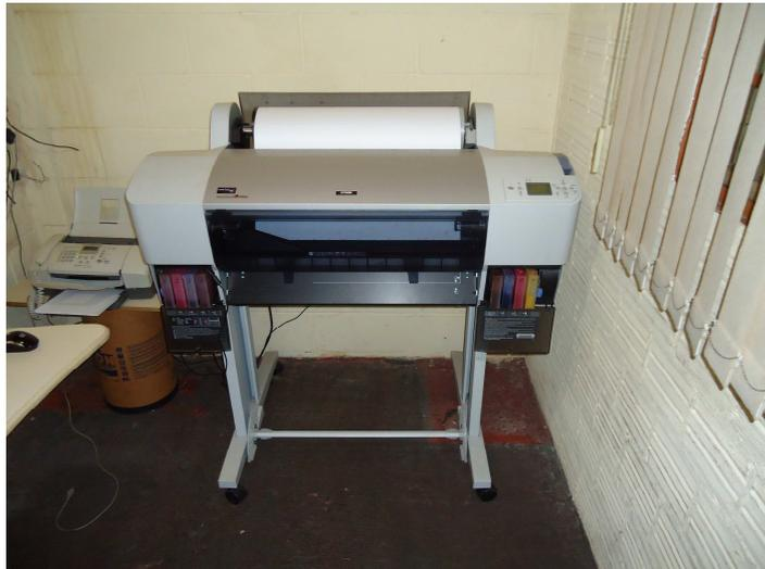
**Figura 18 – Impressora adaptada para sublimação**
