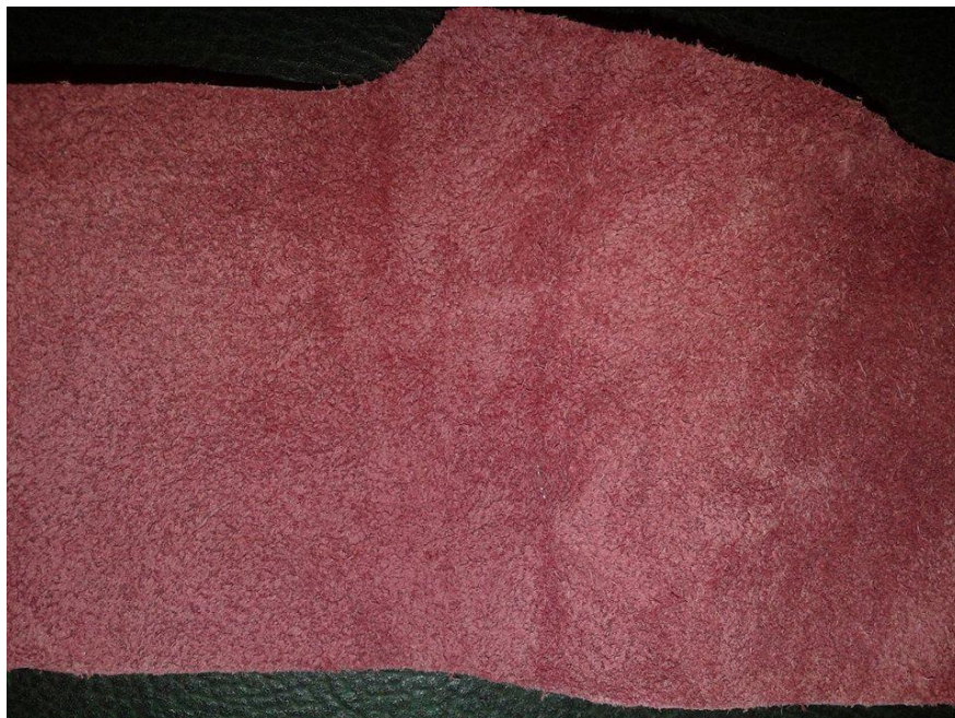
Figura 31 - Couro tingido utilizando corante reativo. Fonte: Autores (2015).
