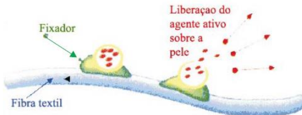
Figura 6 – Atuação das microcápsulas
