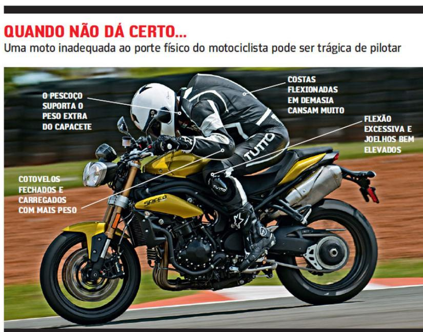
Figura 15 – Comprometimento da postura do corpo com a escolha inadequada da motocicleta
