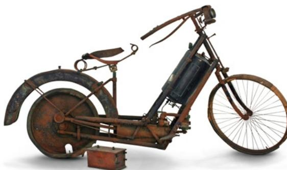
Figura 6 – A "Motorrad" ou "La Petrolette" – primeira motocicleta fabricada em escala
