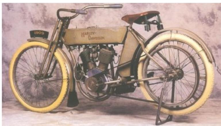
Figura 8 – Harley-Davidson com motor V-Twin, com propulsor de 7 cv e dois cilindros a 45º
