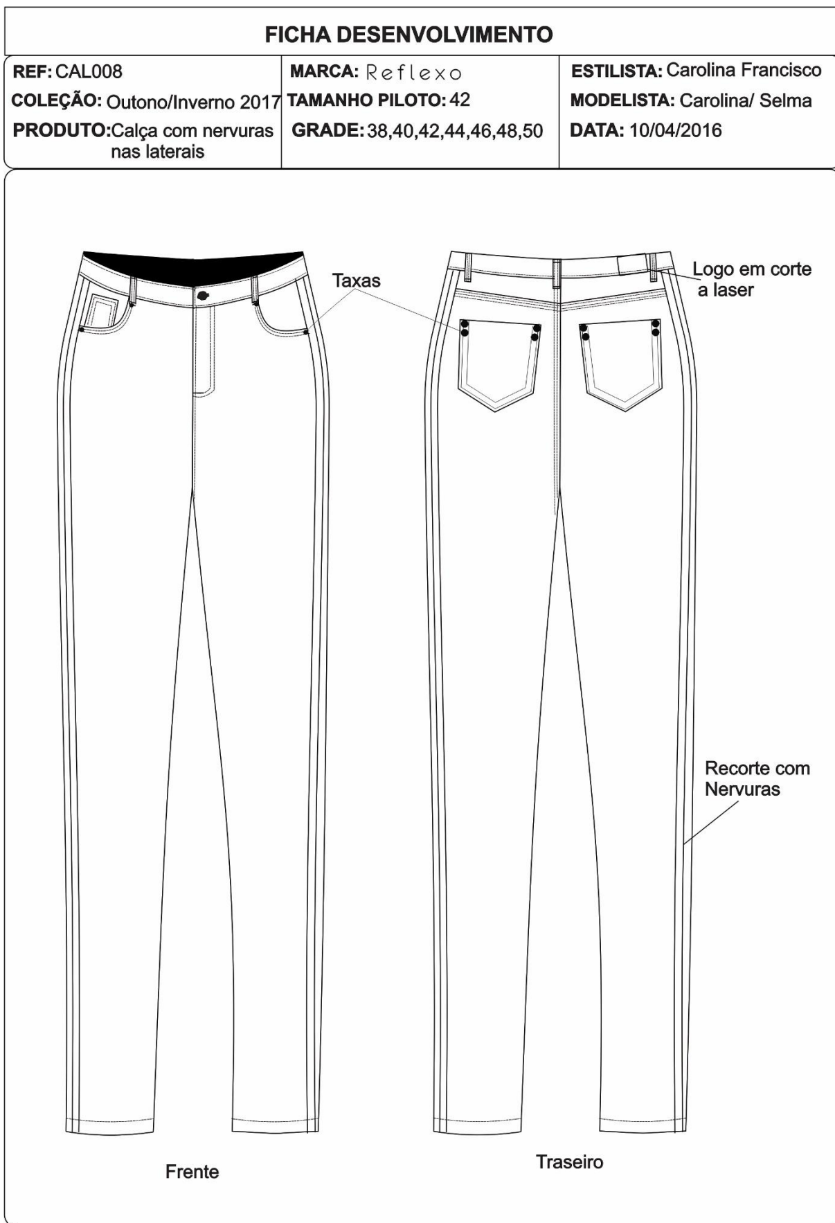
Figura 106: Ficha técnica da calça com nervuras nas laterais (folha 1) Fonte: Da autora (2016)
