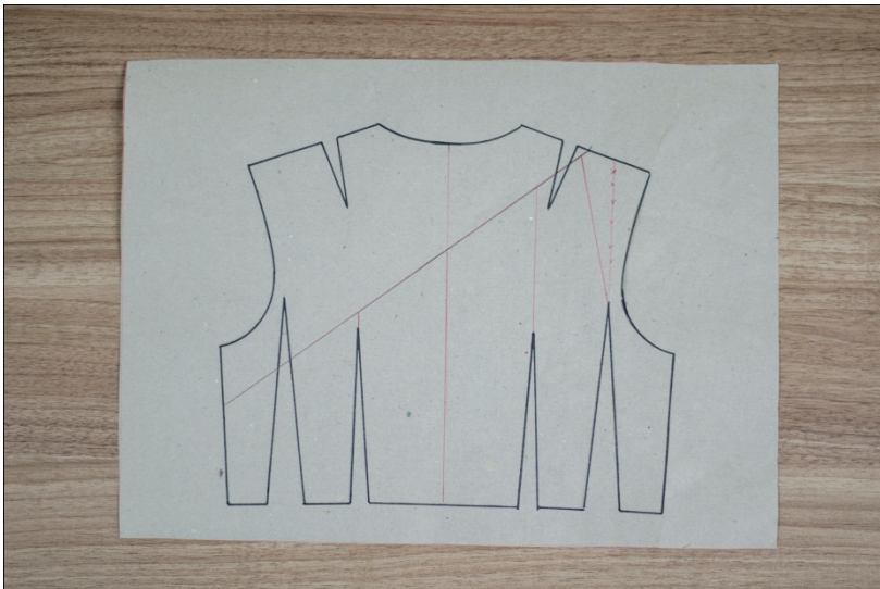
Figura 11 - Delimitação da linha do transpasse e dos recortes a serem abertos Fonte: da autora, 2015.
