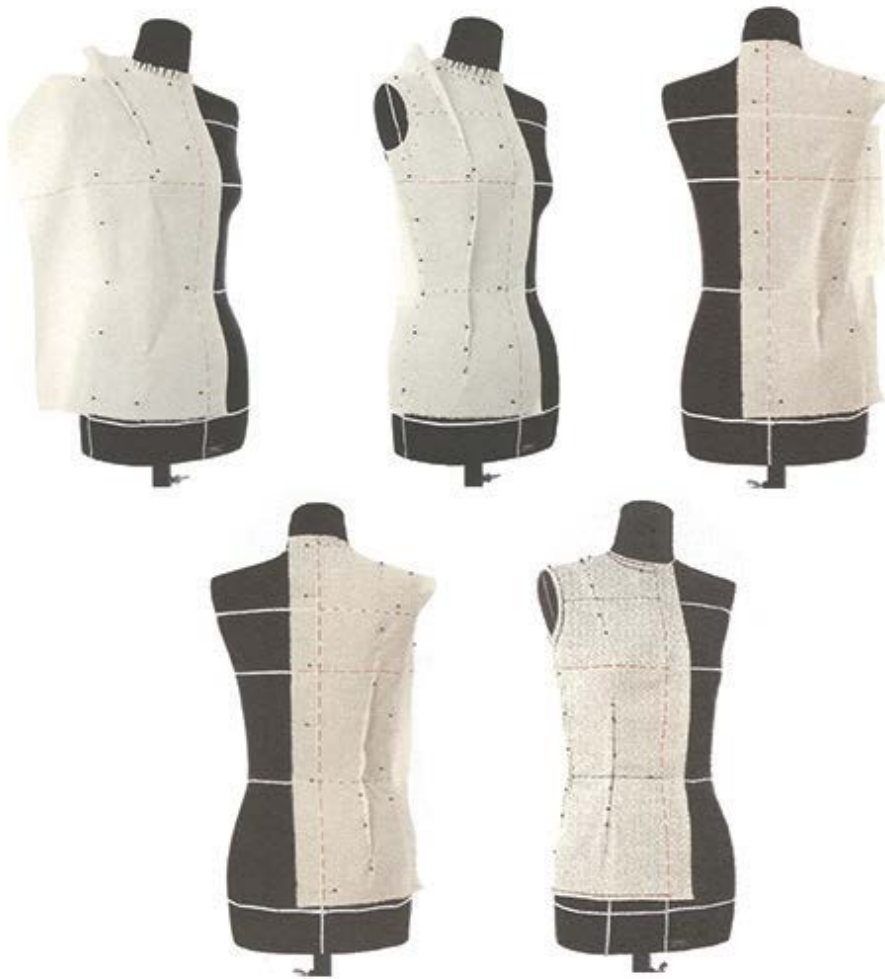
Figura 7 - Construção da base da blusa feminina na modelagem tridimensional Fonte: Duburg e Tol (2012, p. 64 e 65).
