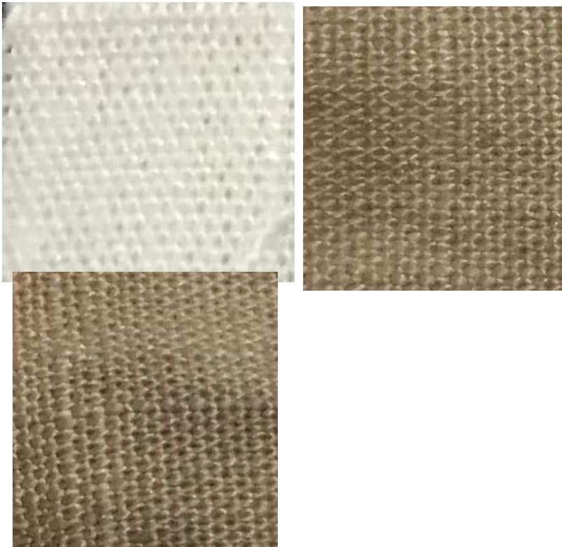
Figura 10 - Imagens fotográficas de amostras de tecidos de algodão crú e cobertos com AgNPs: A) Tecido Branco (TB), B) Tecido com 0,67% [m/v] \text{AgNO}_3 (TAg67) e C) Tecido com 0,17% [m/v] \text{AgNO}_3 (TAg17).
