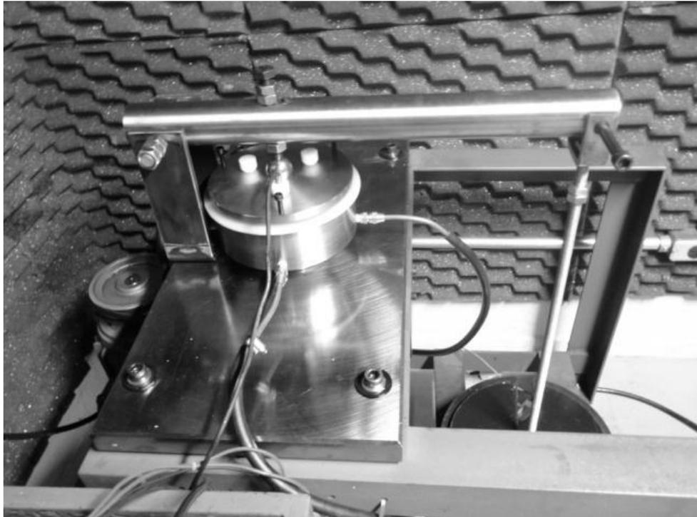
Figura 36 – Equipamento de fadiga de contato do LASC da UTFPR.
