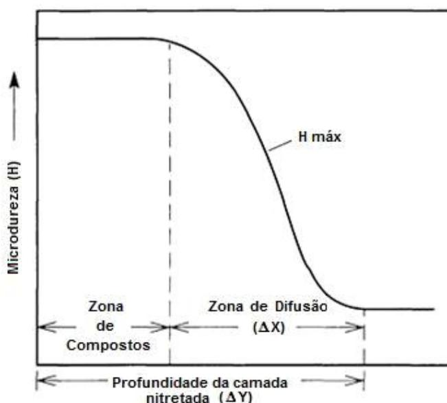
Figura 15 – Esquema do perfil de dureza de um aço nitretado [ASM, 1991].
