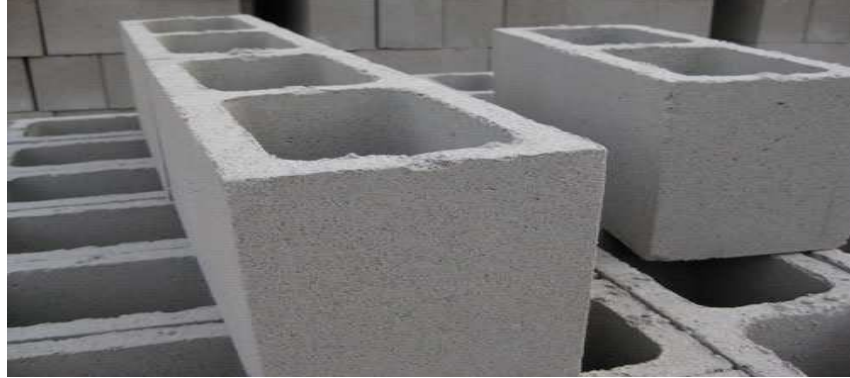
Figura 5: Bloco de concreto inteiro.
