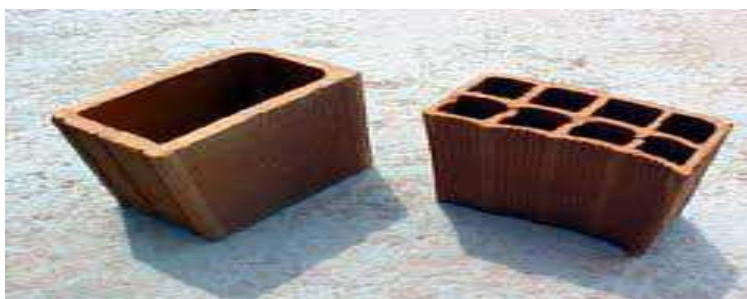
Figura 2 – Bloco cerâmico com defeito. Fonte: Inmetro.
