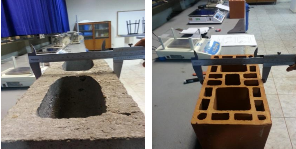
Fotografia 2 – Análise dimensional dos blocos. Fonte: O autor.
