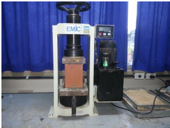
Fotografia 6 – Ensaio de resistência à compressão dos blocos. Fonte: O autor.
