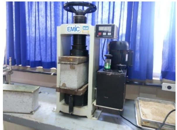
Fotografia 6 – Ensaio de resistência à compressão dos blocos. Fonte: O autor.
