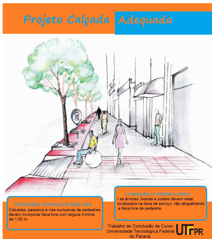
Figura 26: Cartaz orientando sobre calçada acessível. Fonte: Autor (Figura modificada a partir da ilustração do Arquiteto Paulo S. Borges Barreto; Prefeitura Municipal da Serra, 2008, p. 1).
