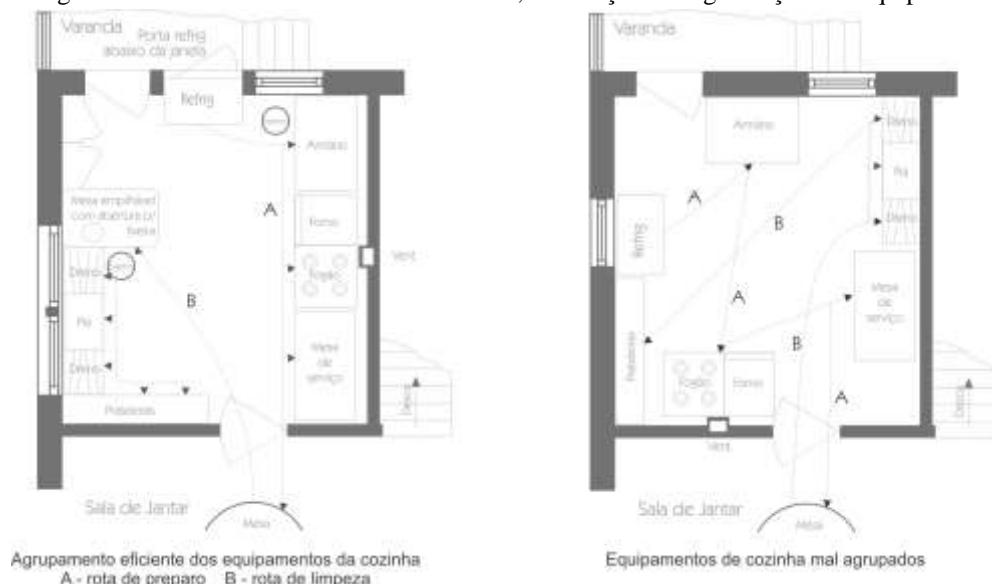
Figura 7 – Estudo de movimentos na cozinha, em função da organização dos equipamentos
