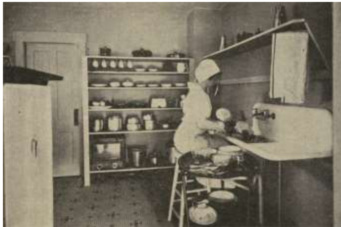
Figura 8 – Postura sentada para lavar a louça; Carrinho para carregar a louça suja, prateleiras adjacentes para organizar os utensílios
