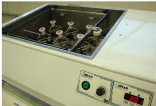
Figura 8 - Banho termostático com agitação - DIST (UTFPR - Campus Apucarana).
