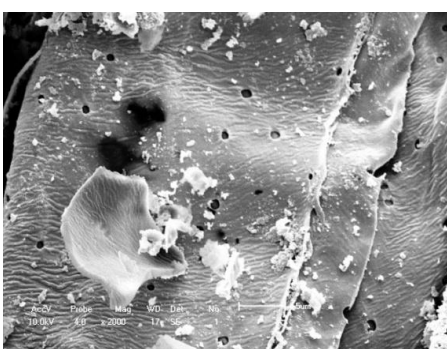
Figura 12 - MEV bagaço de cana calcinado a 500° C (2000 X)
