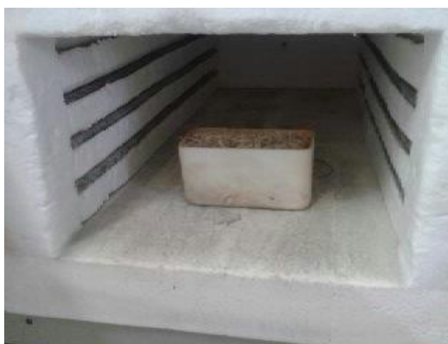
Figura 4 - Etapa de calcinação do bagaço de cana-de-açúcar
