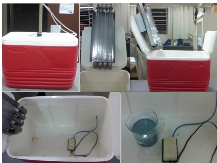
Figura 1 – Componentes do reator fotocatalítico utilizado neste trabalho.
