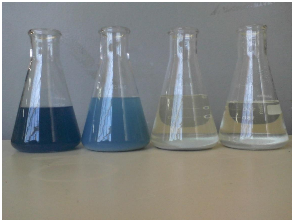
Figura 12 – Comparação entre o efluente antes do tratamento, a mistura do efluente com o catalisador, o efluente após o tratamento (Ensaio 13) e água destilada, da esquerda para a direita.
