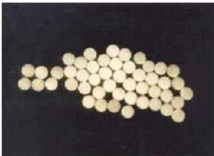
Figura 3: Poliéster circular - corte transversal.
