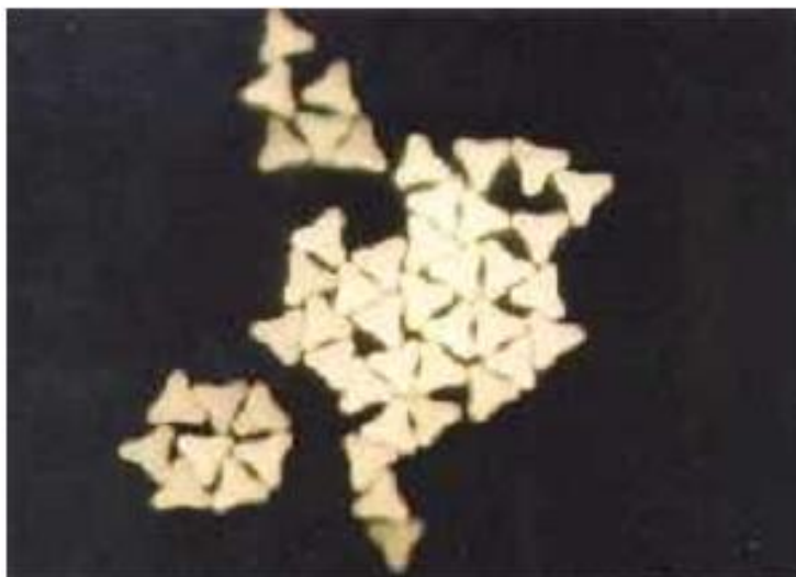
Figura 4: Poliéster trilobal - corte transversal.
