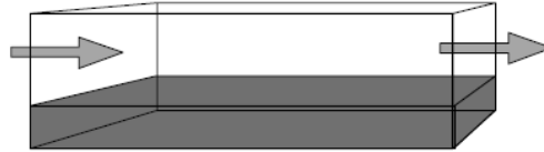
FIGURA 56 - ESQUEMA DE UM DESARENADOR RETANGULAR DE FLUXO HORIZONTAL
