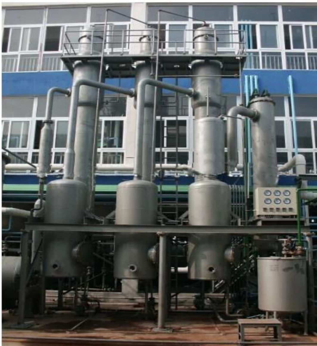
Figura 32 - Evaporador de múltiplo efeito adquirido pela MDLGV.
