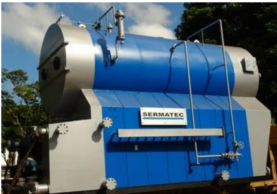
Figura 46 - Imagem ilustrativa da caldeira flamotubular adquirida pela MDLGV.
