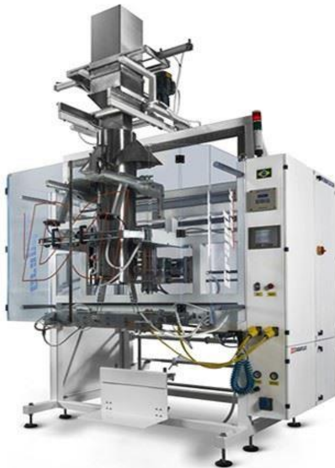
Figura 40 - Imagem ilustrativa do sistema de empacotamento automático dos produtos MDLGV.
