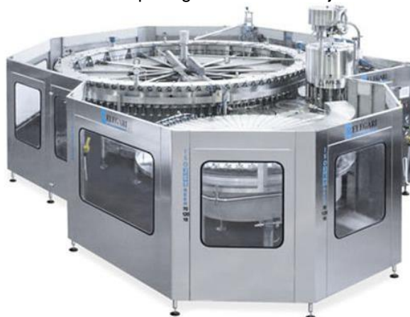
Figura 22 – Envasadora para garrafas de cerveja da marca ISOJET
