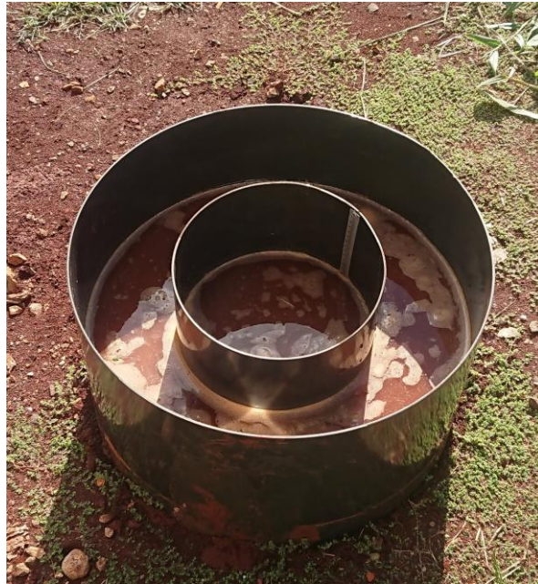
Figura 9: Teste de infiltração com anéis duplos
