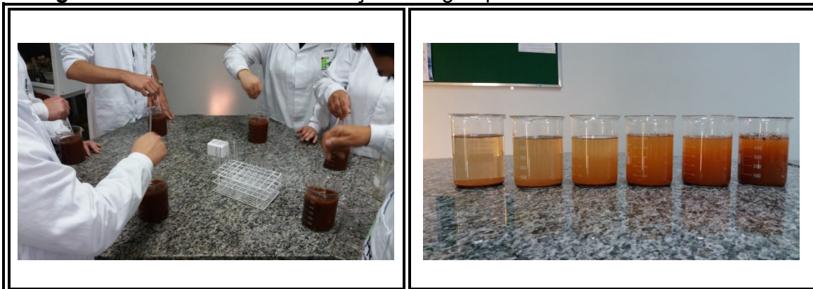
Fotografia 10 – Ensaio da clarificação da água pelos alunos
