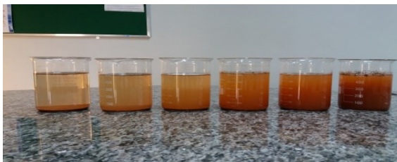
Figura 8 – Término da clarificação manual da água Fonte – Próprio autor
