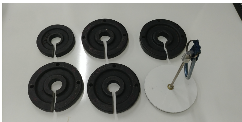
Figura 40 – Suporte e anilhas utilizados para obtenção da curva de calibração da célula de carga.
