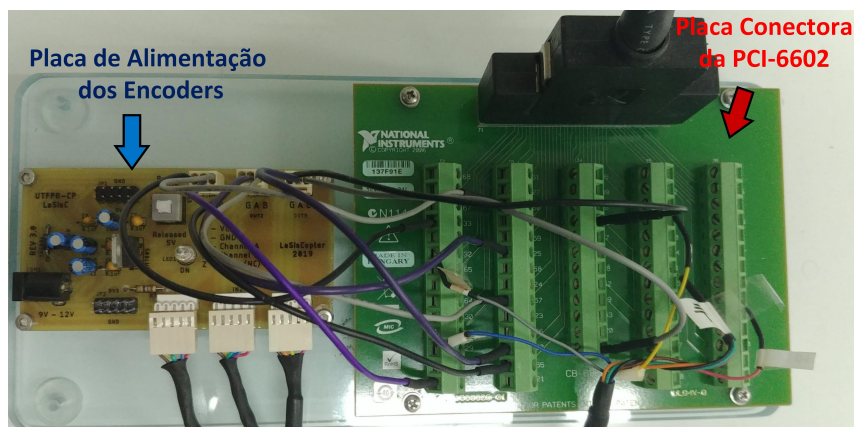
Figura 67 – Estrutura de acrílico com a placa de alimentação dos encoders e a placa conectora da PCI-6602.
