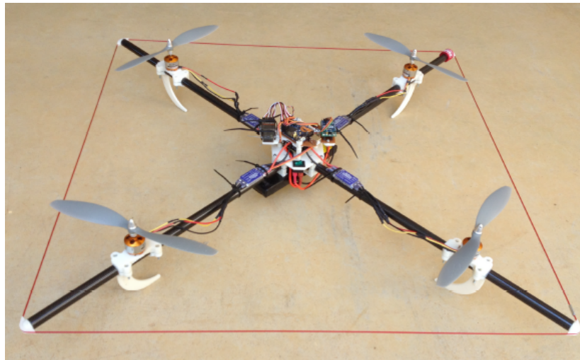
Figura 7 – Quadricóptero construído para estudo das técnicas de controle.
