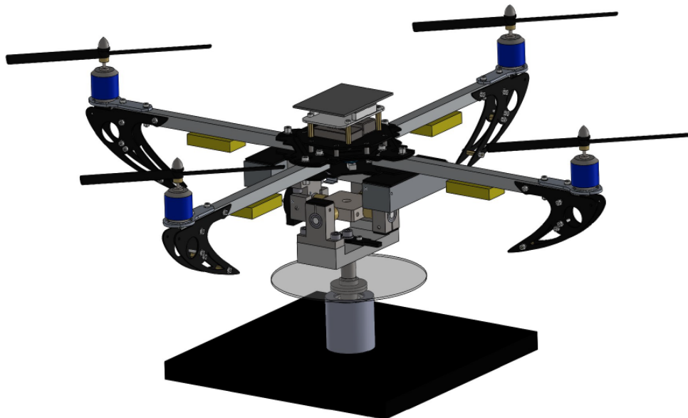
Figura 34 – Montagem do modelo 3D da plataforma experimental.
