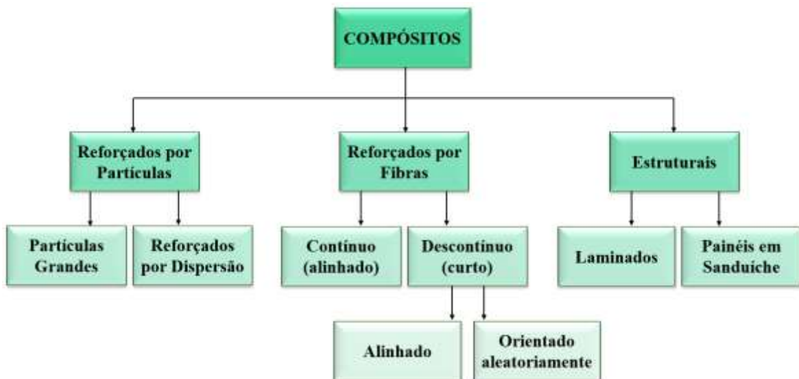
Figura 2.3 – Esquema de classificação dos materiais compósitos Fonte: Adaptado de Callister e Rethwish (2010).
