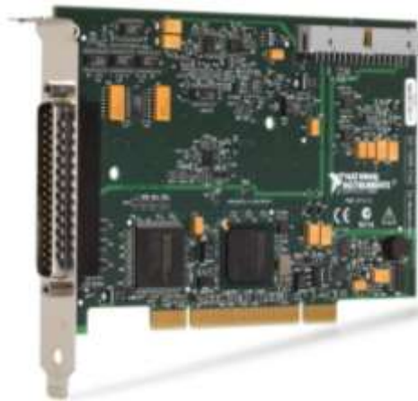
Figura B.1 – Placa de aquisição modelo PCI-6221 Fonte: National Instruments (2019).
