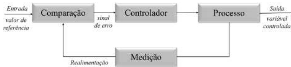
Figura 3.2 - Sistema de controle de malha fechada com retroação Fonte: Adaptado de Ogata (2003).
