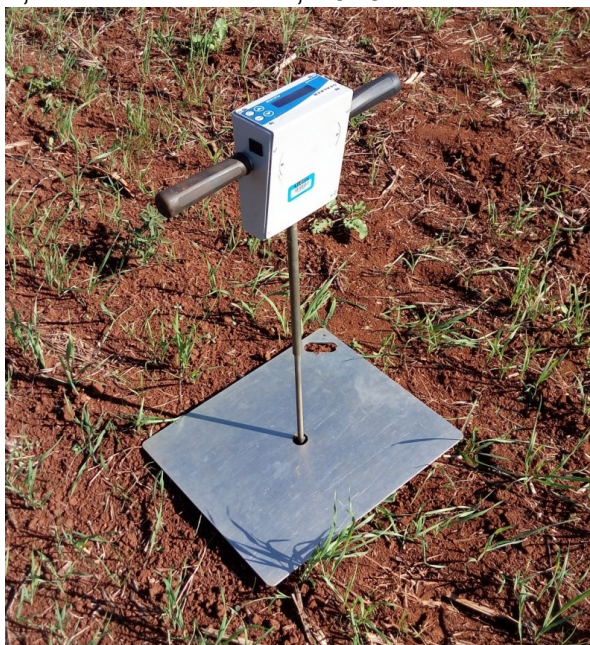
Figura 4. Penetrômetro utilizado para coleta de dados de resistência do solo a penetração. UTFPR, Pato Branco – PR, 2020.
