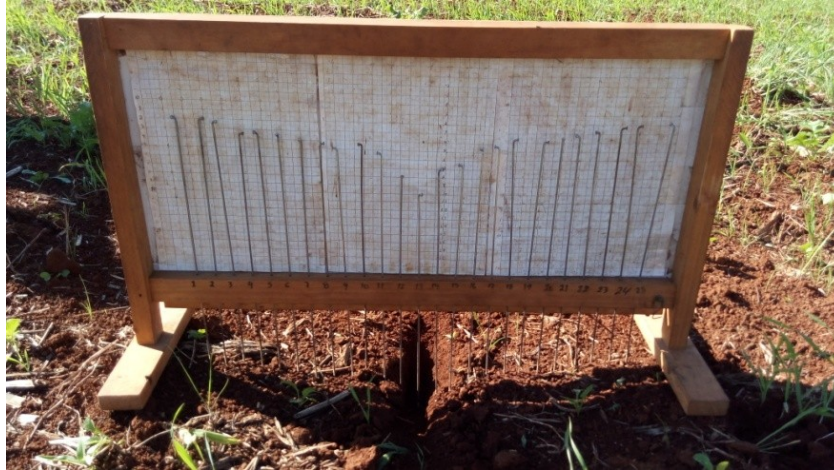
Figura 6. Perfilômetro utilizado na avaliação da área de solo mobilizada, durante a semeadura da cultura do milho. UTFPR, Pato Branco – PR, 2020.
