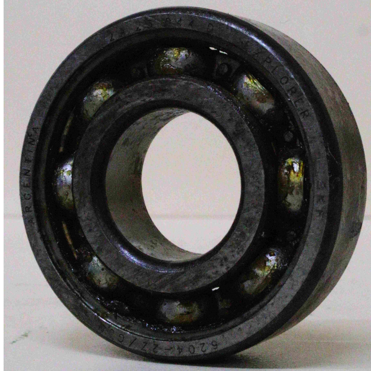
Figura 14 – Rolamento com desgaste.
