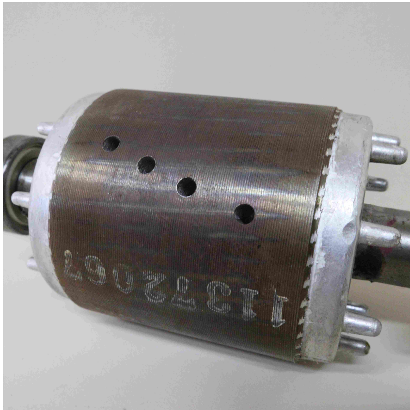
Figura 13 – Rotor com quatro barras quebradas.
