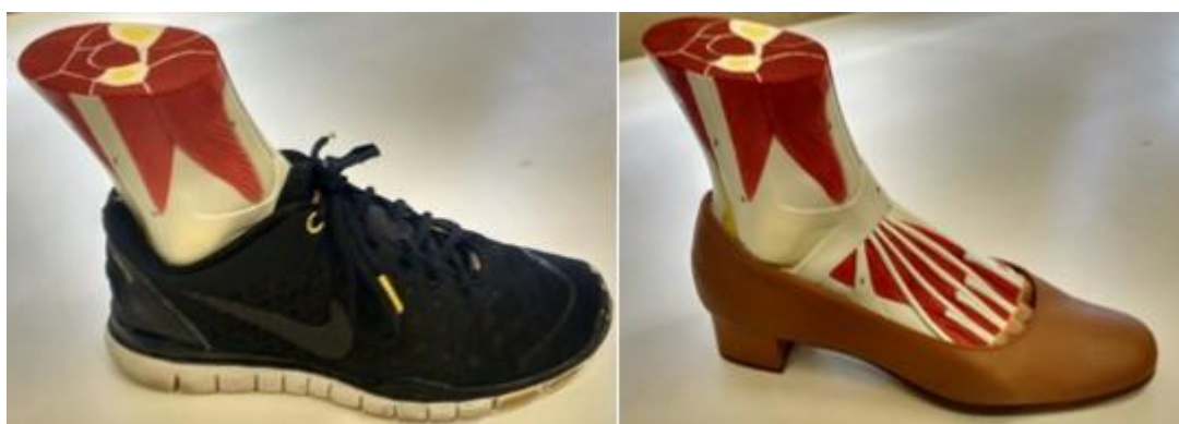
Figura 26: Modelo anatômico de pé instalado nos calçados utilizados nos ensaios de marcha.
