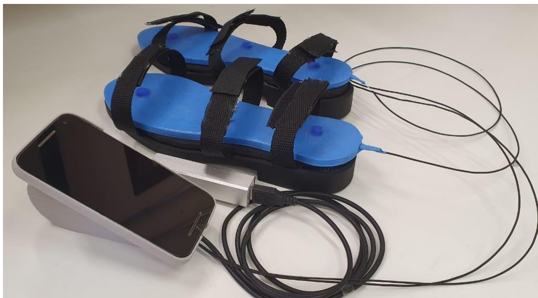
Figura 49: Montagem do sistema sensor
