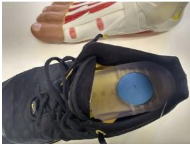
Figura 24: Demonstração da palmilha instrumentada em um calçado.
