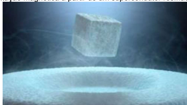
Figura 9: Levitação magnética a partir de um supercondutor resfriado abaixo de T_c .
