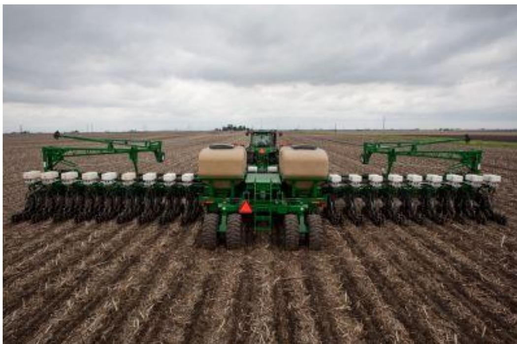
Figura 1 - Semeadora equipada com o sistema *Precision Seed System*, adaptada para plantio de milho em linhas gêmeas.
