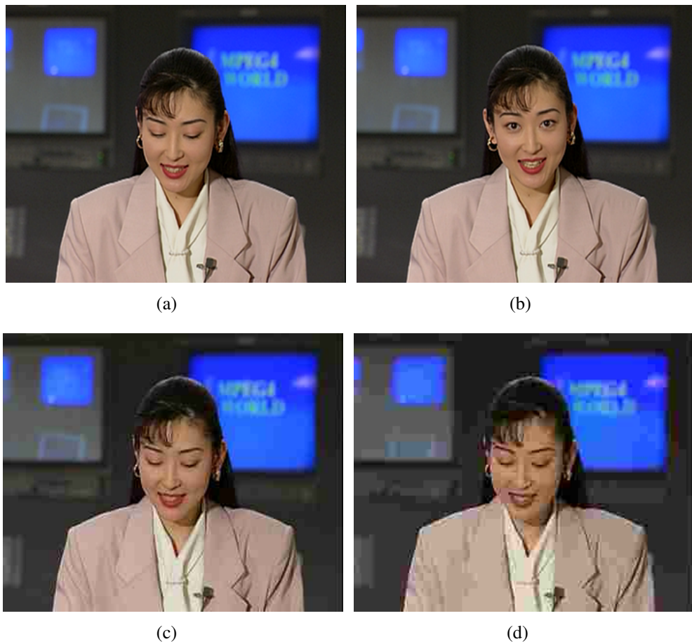
Figura 1: Exemplo de artefato de travamento ( frame freezing ou jerkiness ). Sequência de vídeo original entre (a) 7 s (quadro 175) e (b) 9 s (quadro 225), transmissão da sequência de vídeo contendo artefatos de compressão entre (c) 7 s (quadro 175) e (d) 9 s (quadro 225) com o artefato de travamento.
