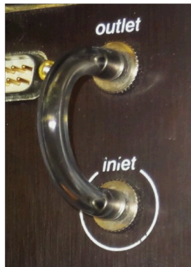
Figura 12 - Conexão direta entre o in e o out do equipamento para medida de background em função do tempo
