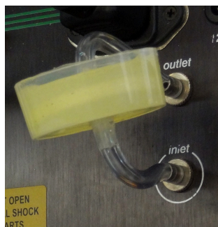
Figura 13 – Conexão direta entre o in e o out do equipamento com o filtro acoplado por meio de cola sintética para medida de background em função do tempo
