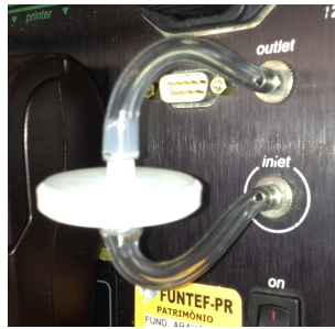
Figura 11 - Conexão direta entre o in e o out do equipamento com o filtro para medida de background em função do tempo
