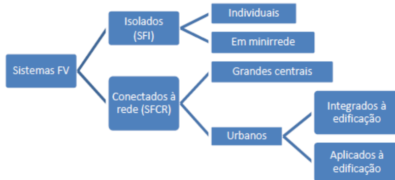
Figura 2: Sistemas Fotovoltaicos - Tipos e Aplicações
