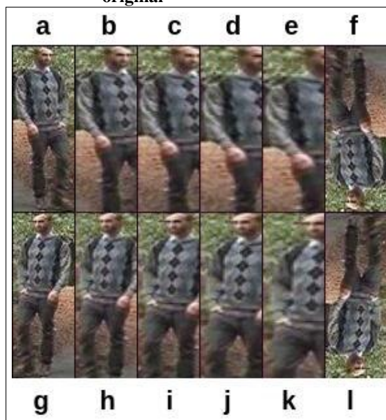
Figura 29 – Resultado da aplicação da técnica de Data Augmentation no dataset VIPeR . A imagem a é a imagem original, enquanto o restante são resultados das transformações aplicadas na imagem original
