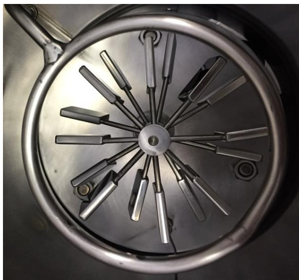
Figura 30 - Porta amostra utilizado no reator a plasma.
