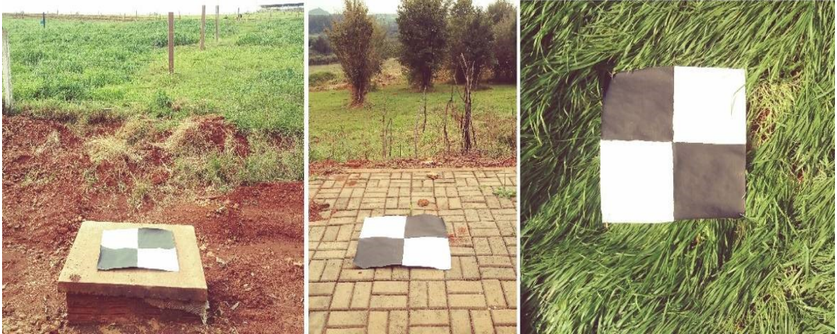
Figura 12 – Pontos de controle distribuídos na área de interesse e sua bordadura.
