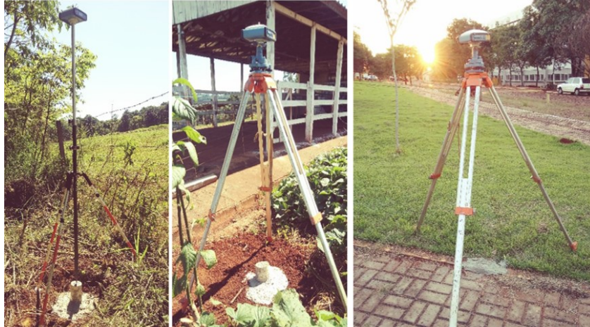
Figura 10 – Pontos de referência implantados e leitura de coordenadas com receptor GNSS no método estático.
