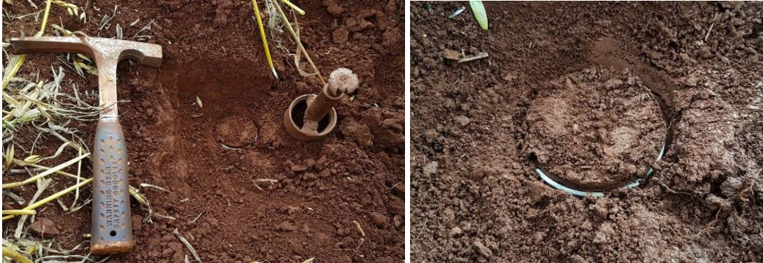
Figura 18 – Coleta de amostras de solo com estrutura preservada com o uso de cilindros volumétricos.
