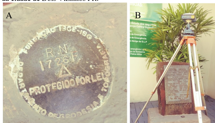
Figura 9 – Chapa do RN 17.261 do IBGE (A) e Receptor GNSS (B) realizando leitura estática no RN 17.261 no centro da cidade de Dois Vizinhos PR.
