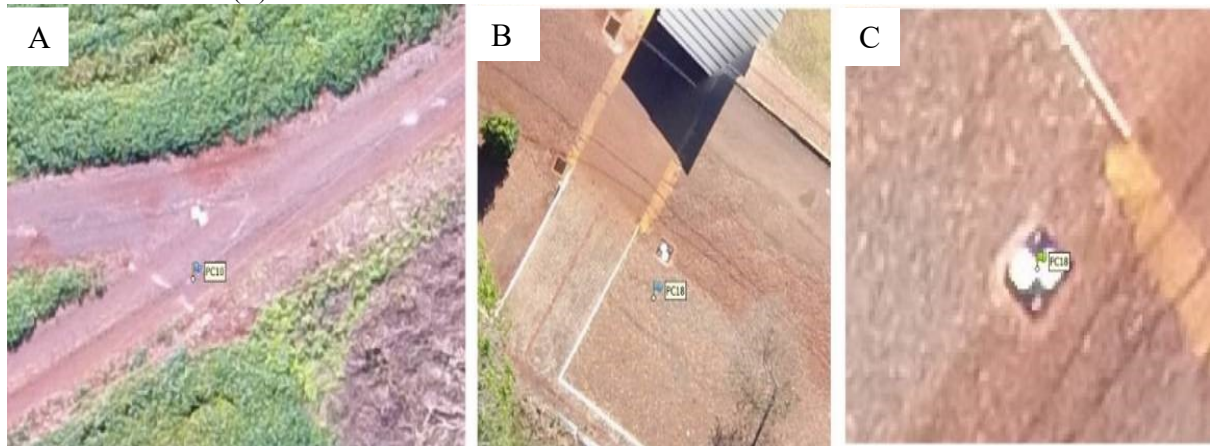
Figura 14 – Pontos de controle inseridos (A) e (B), e ajustamento de posição dos pontos de controle nas imagens aéreas (C).
