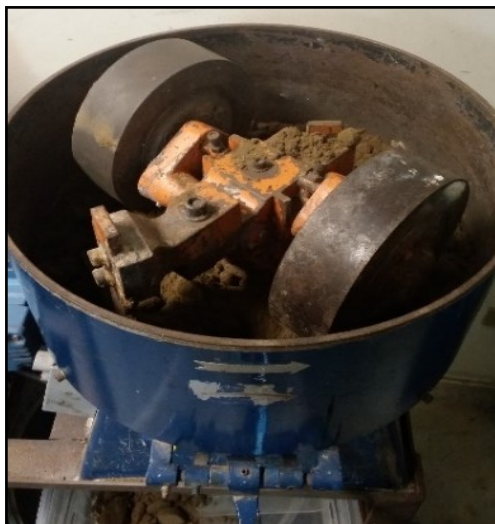
Figura 16 - Misturador de areia mós para fundição
