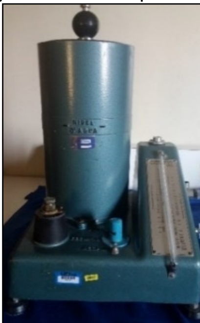
Figura 19 - Permeâmetro para CP de areias a verde
