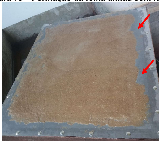
Figura 70 – Formação da folha úmida com falhas
