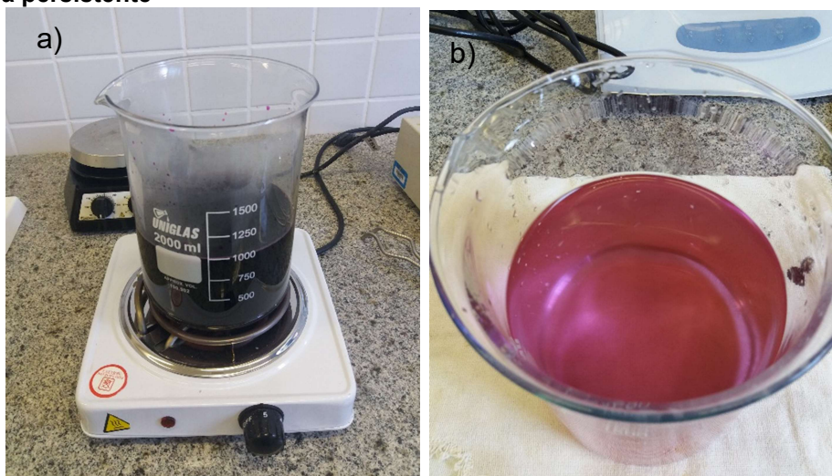
Figura 27 - Equivalente da solução de permanganato de potássio sendo a) início da diluição e b) coloração rósea persistente
