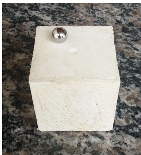
Figura 34 - Marca da esfera de aço resultante do ensaio de dureza superficial sobre os corpos de prova
