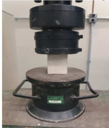
Figura 32 - Ensaio de compressão axial no gesso reciclado
