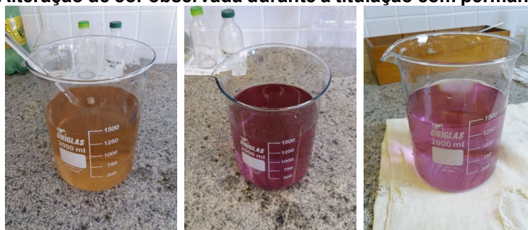
Figura 29 – Alteração de cor observada durante a titulação com permanganato de potássio
