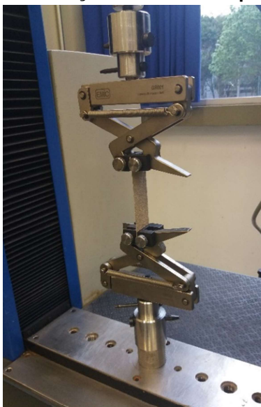
Figura 42 – Ensaio de resistência à tração nas folhas de papel cartão recicladas
