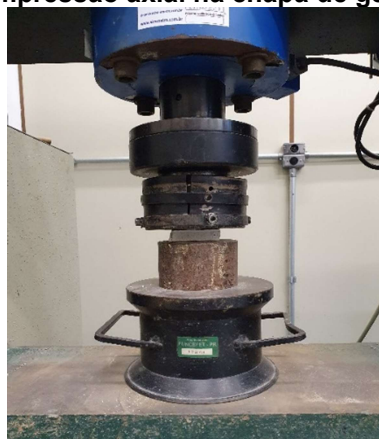
Figura 48 - Ensaio de compressão axial na chapa de gesso acartonado
