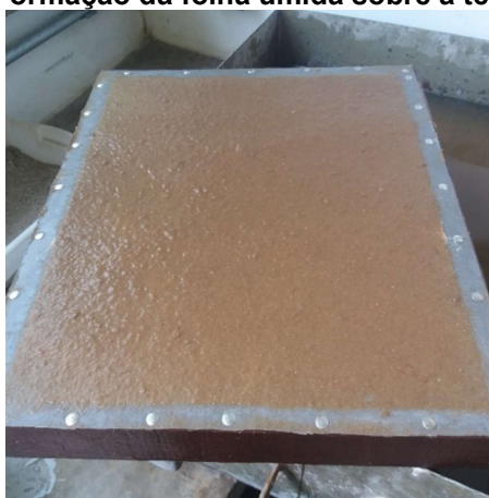
Figura 40 – Formação da folha úmida sobre a tela metálica
