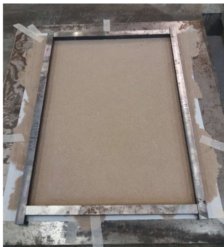
Figura 44 – Molde metálico de dimensões internas 30 x 40 cm posicionado sobre a folha de papel reciclada
