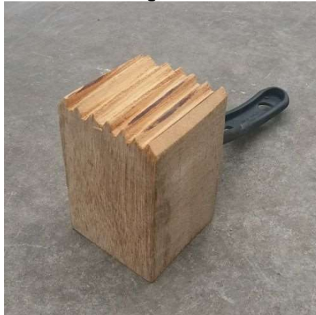
Figura 39 – Martelo de madeira corrugada utilizado na refinação da pasta celulósica
