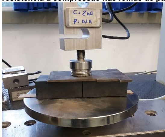
Figura 43 – Ensaio de resistência à compressão nas folhas de papel
