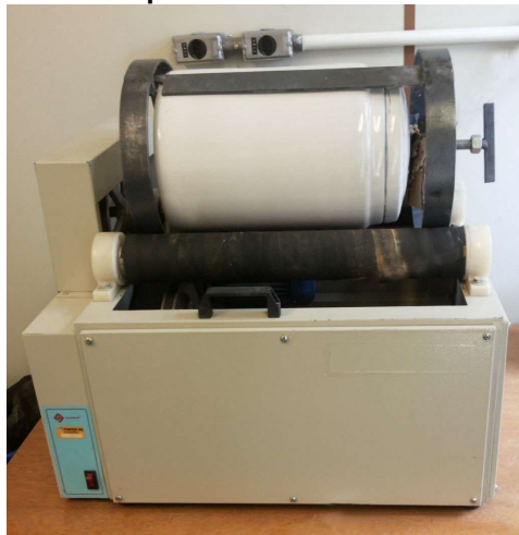
Figura 26 - Moinho de bolas de porcelana com esferas de ágata
