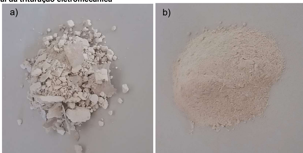
Figura 25 – Granulometria do gesso reciclado sendo a) início do da trituração eletromecânica e b) final da trituração eletromecânica
