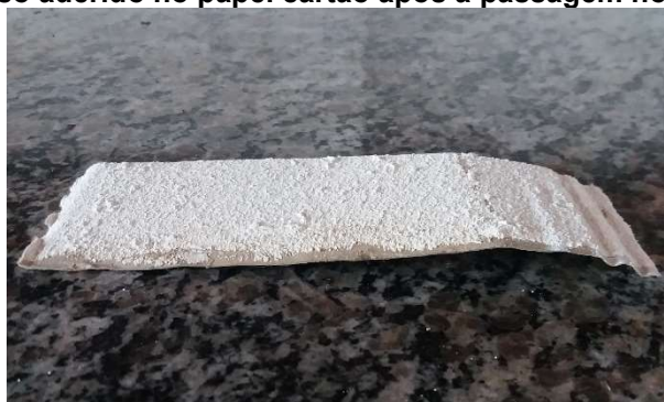
Figura 23 – Gesso aderido no papel cartão após a passagem no cilindro manual
