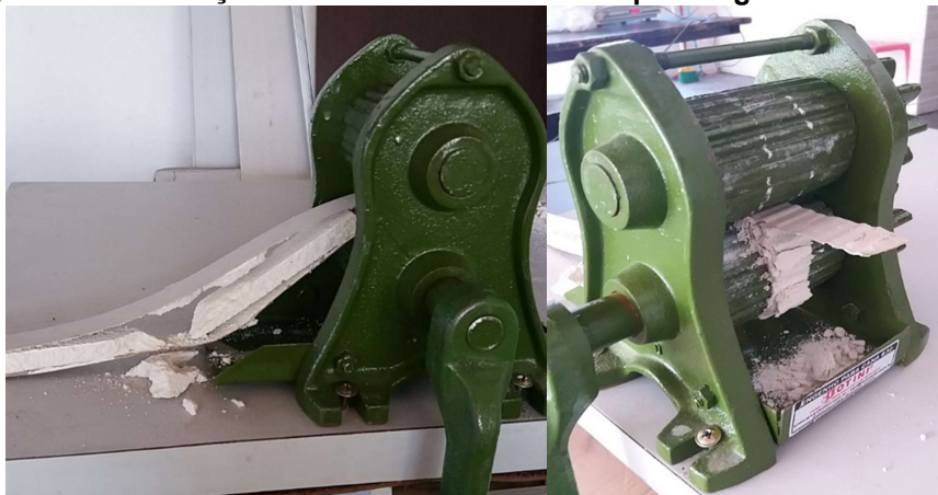
Figura 22 – Trituração manual do resíduo de chapas de gesso acartonado
