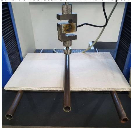
Figura 47 – Ensaio de resistência mínima à ruptura na flexão
