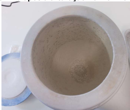
Figura 50 - RG após a trituração no moinho de bolas
