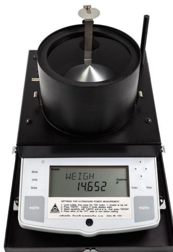
Figura 18 - Calibração da balança ultrassônica Ohmic Instruments UPM-DT-1 utilizando o peso padrão de 1 g, que equivale a uma potência de 14,65 W.
