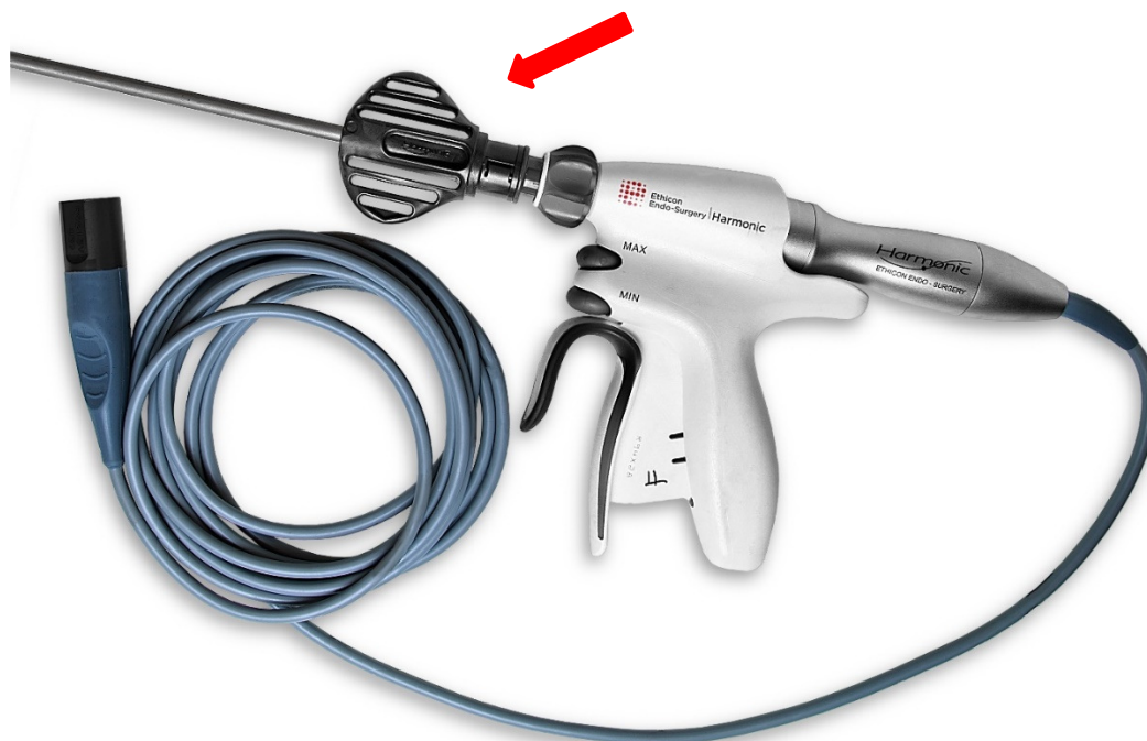
Figura 11 - Montagem da tesoura ultrassônica e peça de mão. A chave borboleta indicada com a seta é utilizada para realizar a pressão e o acoplamento adequado entre a tesoura e a peça de mão.
