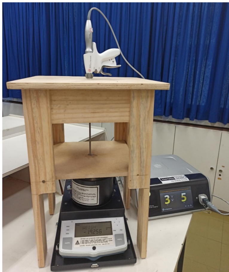
Figura 17 - Configuração para realizar os testes, incluindo suporte, tesoura ultrassônica, balança ultrassônica e gerador GEN11.
