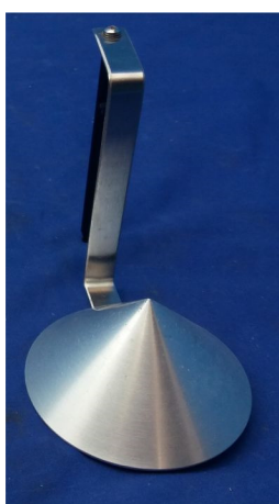
Figura 14 - (a) Alvo cônico utilizado na balança ultrassônica Ohmic Instruments UPM-DT-1; (b) Mini tanque da balança ultrassônica mostrando o posicionamento do alvo cônico e as paredes revestidas de borracha para absorção das ondas ultrassônicas.
