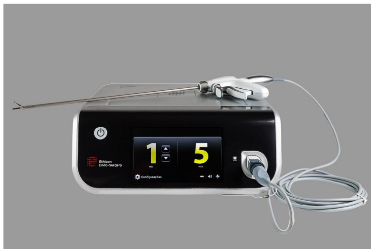
Figura 21 - Configuração do gerador GEN11 para operação no modo de coagulação com menor intensidade (Nível 1).
