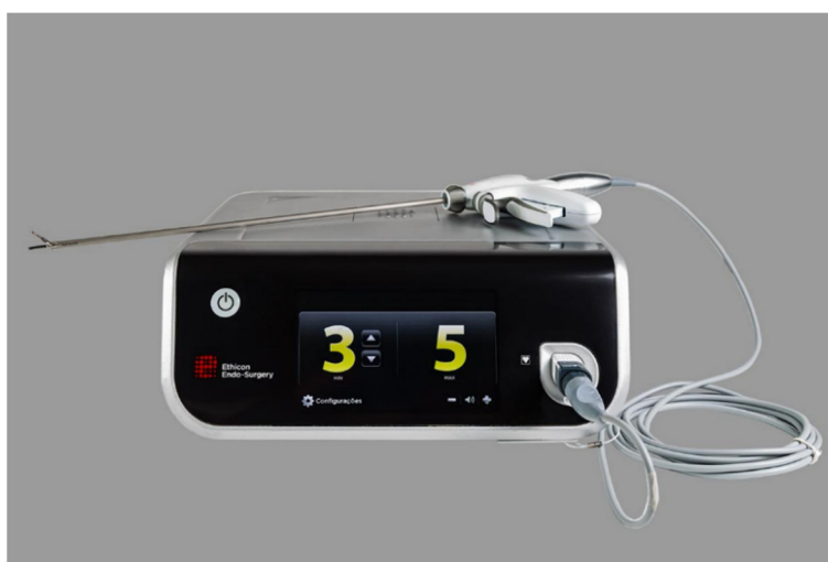
Figura 20 - Configuração padrão do gerador GEN11 para realizar corte (Nível 5) ou coagulação (Nível 3) dos tecidos biológicos moles.
