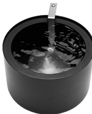
Figura 14 - (a) Alvo cônico utilizado na balança ultrassônica Ohmic Instruments UPM-DT-1; (b) Mini tanque da balança ultrassônica mostrando o posicionamento do alvo cônico e as paredes revestidas de borracha para absorção das ondas ultrassônicas.
