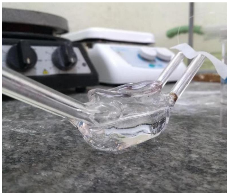
Figura 12 – Recipiente de vidro usado para realizar a deposição das nanopartículas de ouro pela rota térmica sobre as fibras ópticas.
