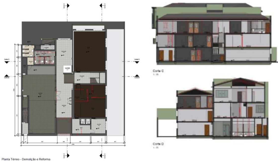
Figura 18 – Projeto da reabilitação compatibilizado com a demolição
