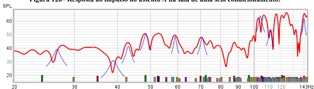
Figura 126– Resposta ao impulso no assento A na sala de aula sem condicionamento.
