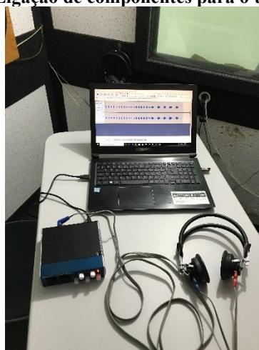
Figura 77– Ligação de componentes para o teste de IPRF.
