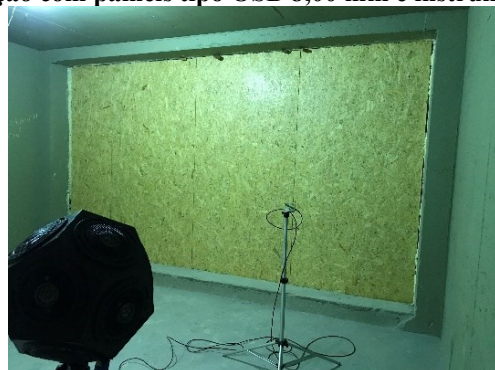
Figura 35– Vedação com painéis tipo OSB 8,00 mm e instrumentos de medição.
