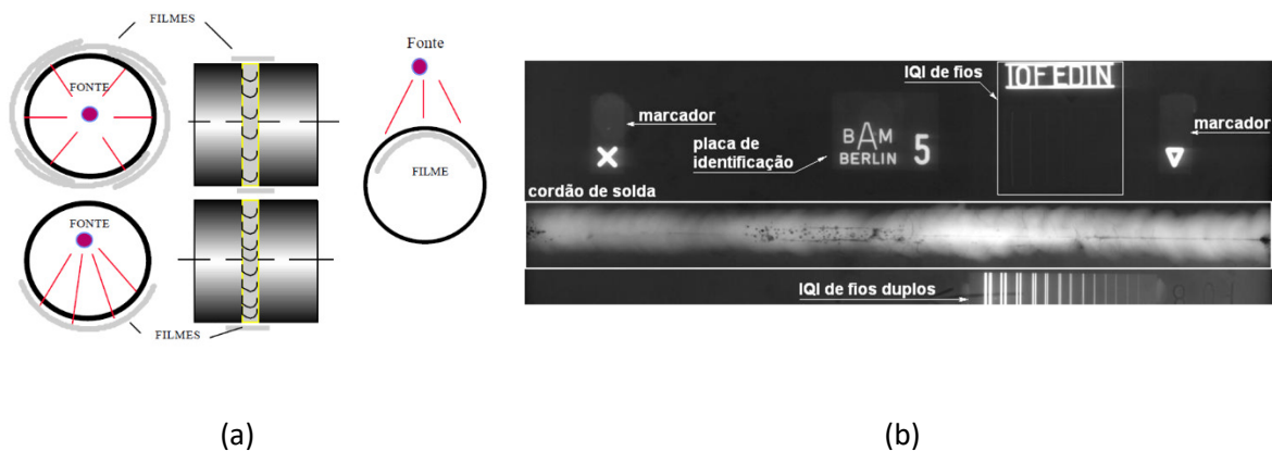
Figura 2 – Técnica de exposição PSVS. (a) Recomendação da posição da fonte de radiação e do detector. (b) Imagem resultante com destaque do cordão de corda e outros artefatos utilizados na identificação.
