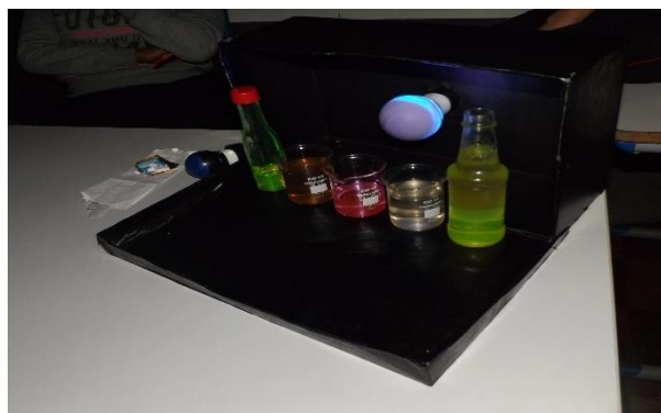
Figura 32 - Materiais fluorescentes como suco de limão, água sanitária e clorofila.
