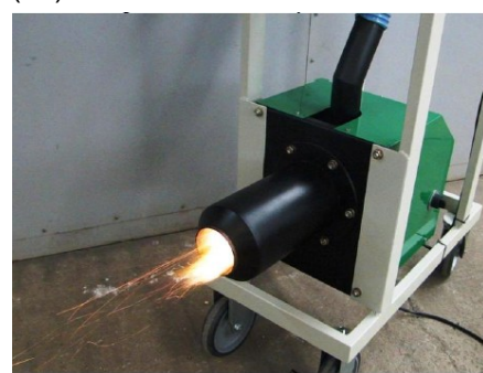
Figura 24 - a - possui uma chama muito fraca e com desperdício de combustível; b - apresenta uma chama pequena e com excesso de ar. Fonte: Matias, 2016.
