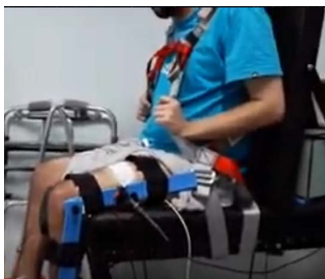
Figura 50 – Voluntário sentado na cadeira extensora seguro por cinto tipo rapel adaptado.
