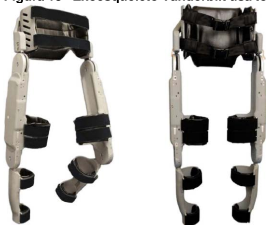
Figura 18 - Exoesqueleto Vanderbilt usa torque motor nas articulações de quadril e joelho
