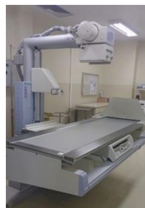
Figura 1. Equipamento de fluoroscopia. Distância foco – isocentro: 95 cm; Distância foco imagem: 115 cm.
