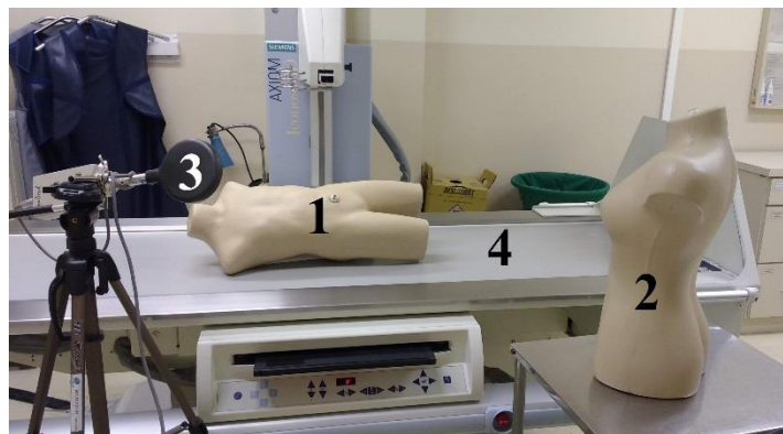
Figura 3 – Configuração experimental. 1) Simulador do paciente pediátrico. 2) Simulador do IOE. 3) Câmara de ionização. 4) Mesa articulada.
