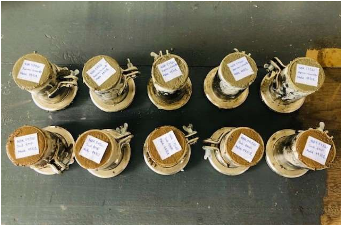
Figura 12 - Verificação do índice de desempenho da pozolana aos 28 dias
