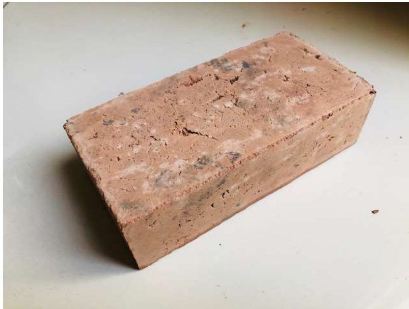
Figura 21 - Tijolo ecológico após desmoldagem
