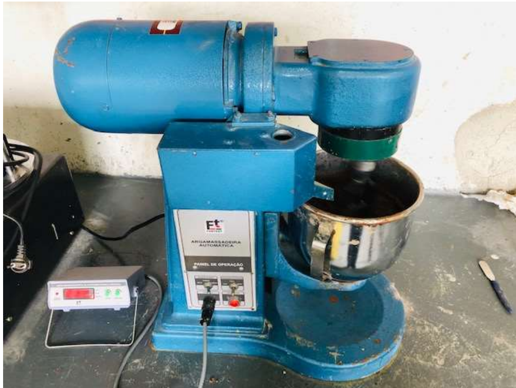
Figura 9 - Argamassadeira mecânica utilizada para das argamassas
