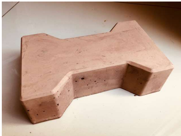
Figura 23 - Paver ecológico após desmoldagem
