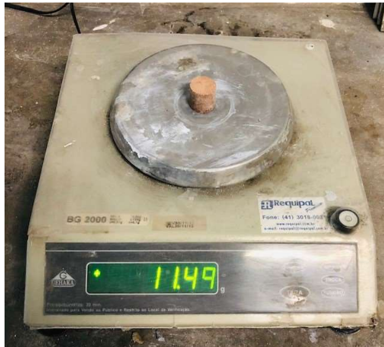
Figura 19 - Medição da massa de um corpo de prova aos 90 dias
