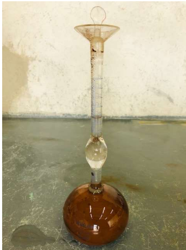
Figura 6 - Determinação da massa específica real do RMF
