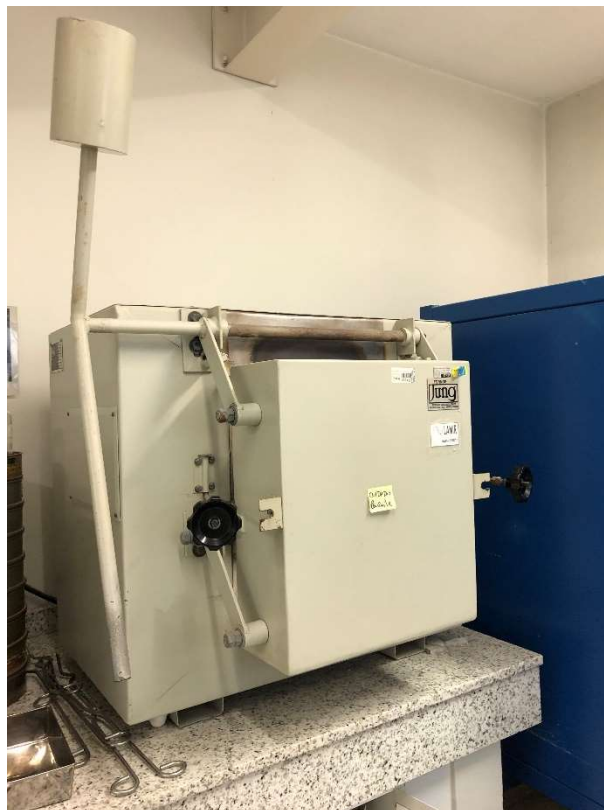
Figura 13 - Forno mufla utilizado para ensaio de PF dos resíduos
