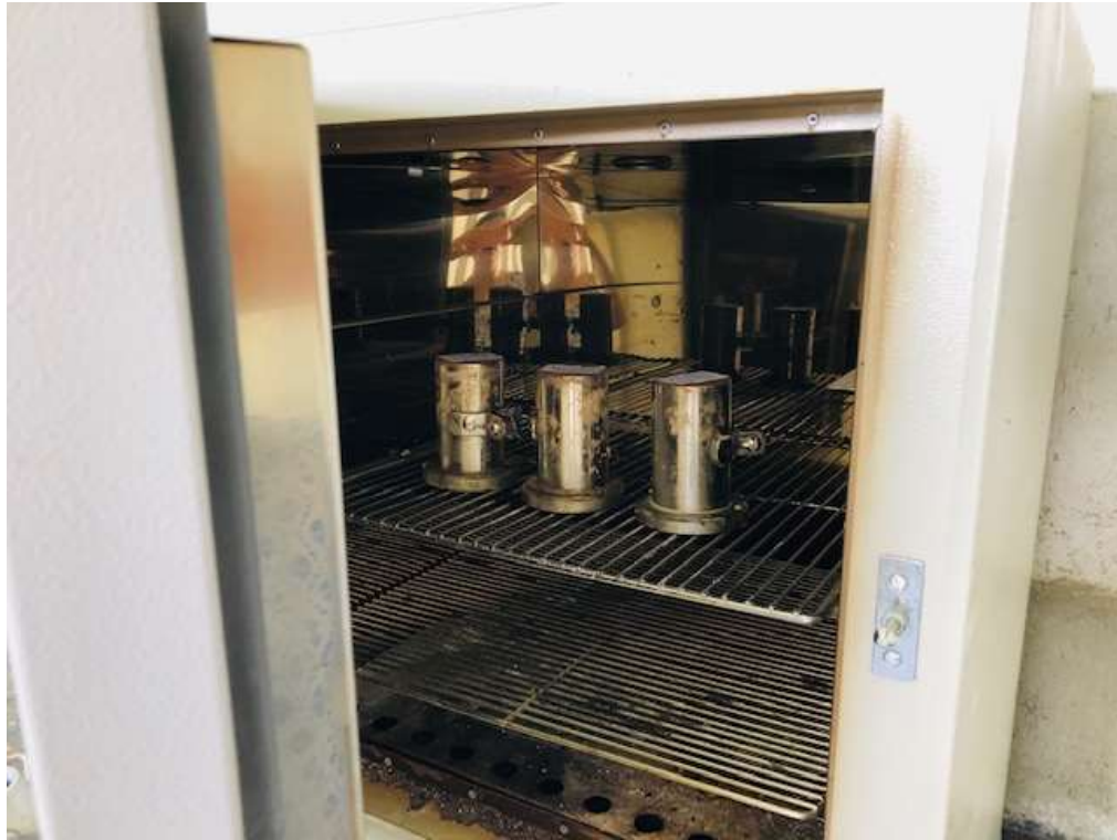
Figura 11 - Cura dos corpos de prova à temperatura de 55°C por 6 dias
