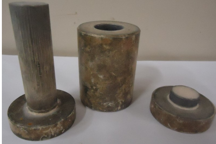
Figura 11 – Conjunto de molde metálico c/ diâmetro e altura de 20mm
