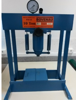
Figura 12 - Prensa manual: Capacidade 10Ton
