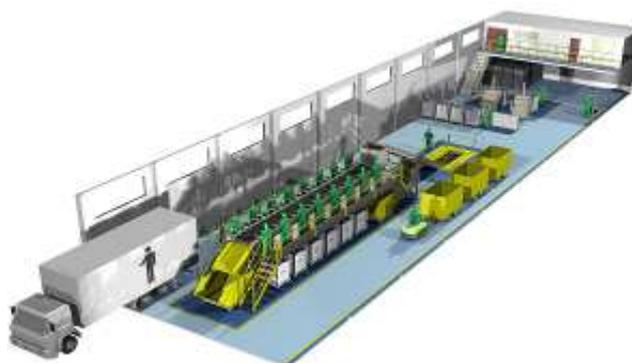
**Figura 10 - Representação ilustrativa do novo *layout* produtivo com área de carregamento proposto à RESOL**
