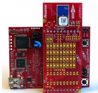
Figura 33. Placa Launchpad conectada à placa wireless, ambos do mesmo fabricante. Fonte: Adaptada de http://www.ti.com/tool/430boost-cc110l#2 , 2011.
