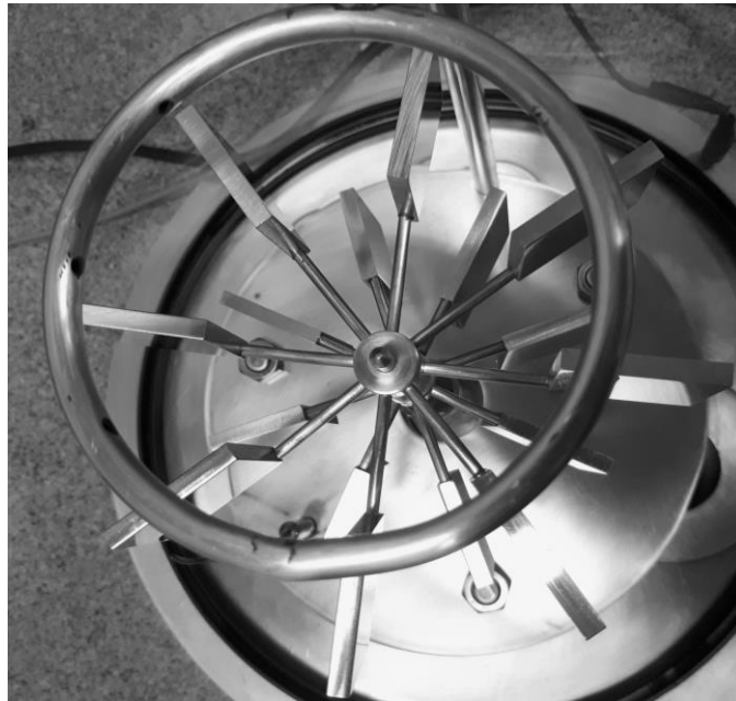
Figura 26 – Sistema “tipo árvore” fabricado para posicionar as amostras dentro do reator de plasma.
