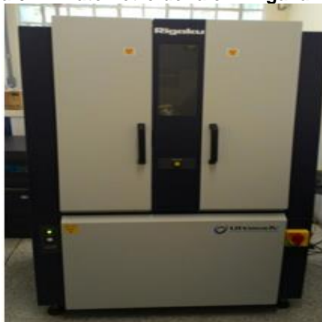
Fotografia 6 - Difratômetro de raio-X Rigaku – Ultima IV
