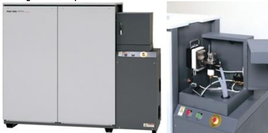
Fotografia 13 - Espectrômetro de Emissão Ótica Shimadzu PDA-7000
