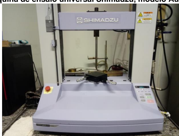
Fotografia 10 - Máquina de ensaio universal Shimadzu, modelo Autograph AGS-X 5kN.
