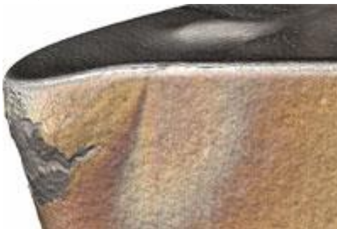
Figura 8 - Deformação plástica da aresta de corte de ferramentas de metal duro.
