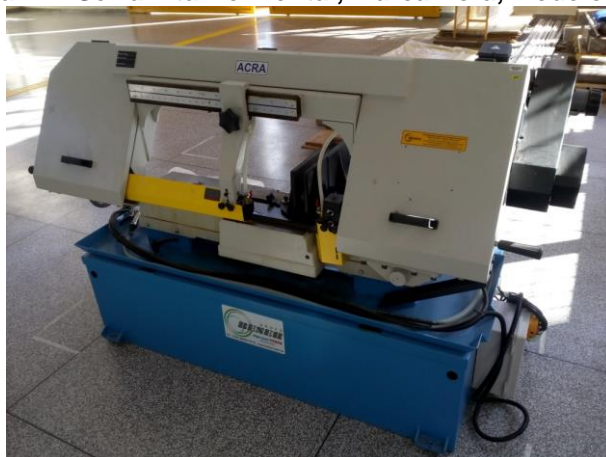
Fotografia 11 - Serra Fita Horizontal, marca Acra, Modelo SBS-1335
