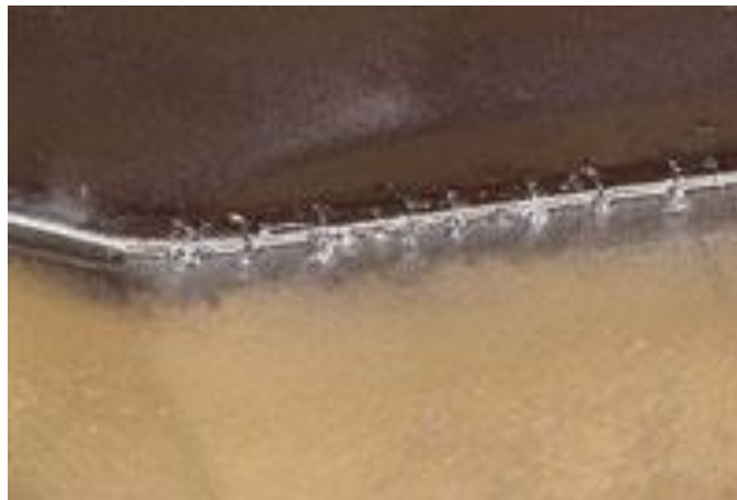
Figura 10 - Trinca térmica presente em ferramentas de metal duro.
