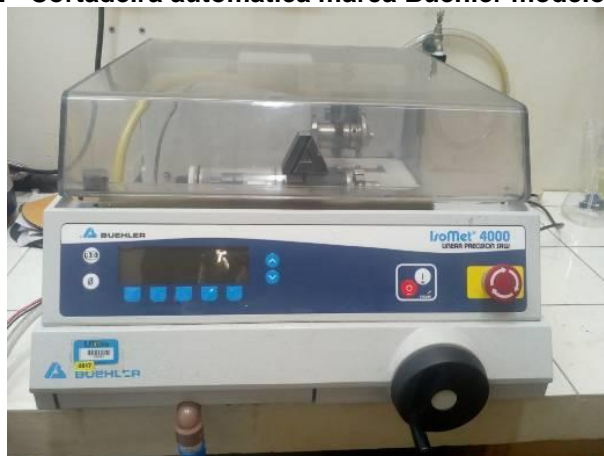
Fotografia 2 - Cortadeira automática marca Buehler modelo Isomet 4000
