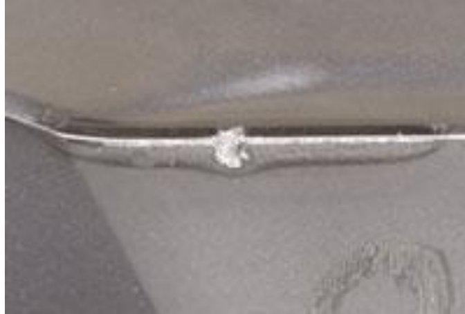
Figura 9 - Lascamento provocado em arestas de corte.
